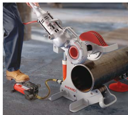
Χρήση του κόφτη σωλήνων μοντέλο 258 με ηλεκτρικό βιδολόγο αρ. 700 για κοπή
