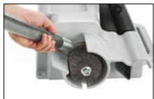
Ο προαιρετικός δίσκος απογρέζωσης χρησιμοποιείται για τη λείανση του χείλους της εξωτερικής επιφάνειας για ευκολότερη εφαρμογή των σφικτιών πρόσθετων εξαρτημάτων
