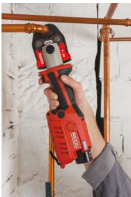
Ανοίγοντας τη σιαγόνα και πατώντας τη σκανδάλη με το ίδιο χέρι, εξοικονομείτε χρόνο και προσπάθεια!
