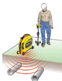
Επαγωγή σήματος για τον εντοπισμό εγκαταστάσεων.
