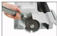
Afgratningskiven (ekstraudstyr) bruges til at slibe den ydre kant som en hjælp ved stramme fittings
