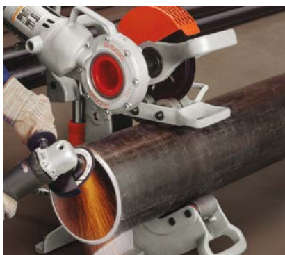
Model 258 med rørvalse i brug ved affasning. Der anbefales to operatører til dette arbejde
