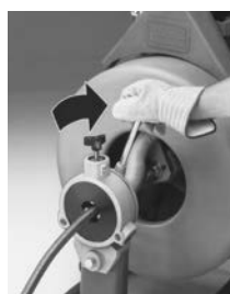
Tilbagetrækning af kabel
