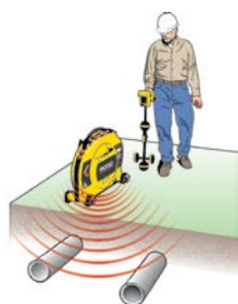
Induktion af signal til lokalisering af installationer.
