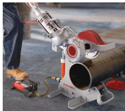
Model 258 rørskeerer med nr. 700 rørdrev i brug ved skæring
