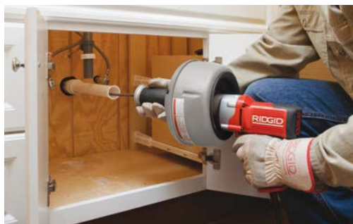
Model K-45AF åbner hurtigt stoppede ledninger. Skyder spiralen frem og trækker den ind uden at vende motoren.
